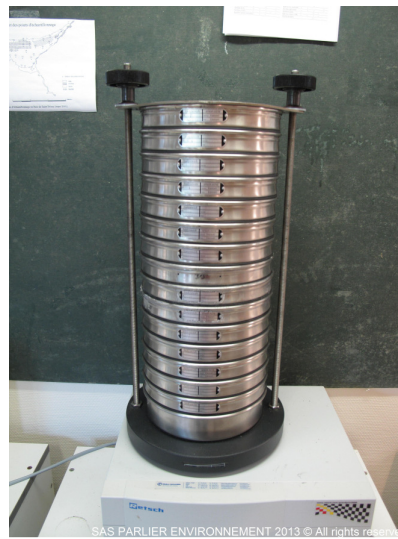
Figure 5: Colonne granulométrique (AFNOR) à tamis mécaniques RETSCH de 2000 à 40 microns. (PARLIER ENVIRONNEMENT SAS 2013)
