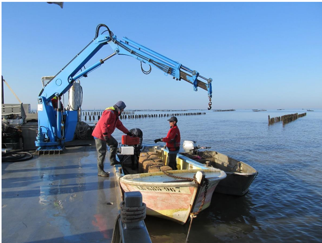
Figure 7 : Navires mis en œuvre pour l'arrachage des pieux (CRC, 17)
