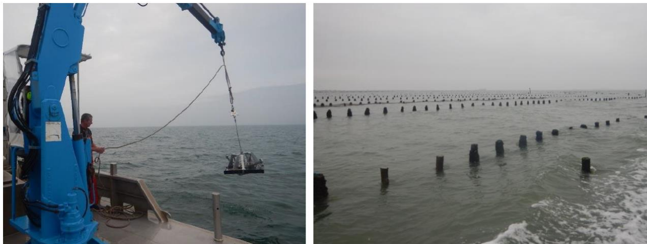
Figure 23 : Utilisation de la benne « Day » (surface d'échantillonnage de 0.1 m 2 ) dans les bouchots (Idra Bio & Littoral, 2020)
