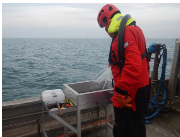
Figure 4 : Tamisage sur maille ronde de 1mm
