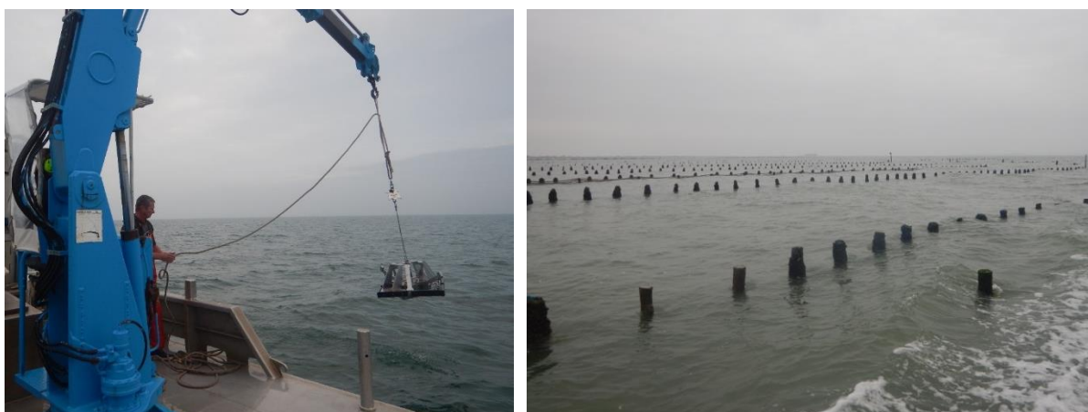
Figure 2. Utilisation de la benne « Day » (surface d'échantillonnage de 0.1 m 2 ) dans les bouchots
